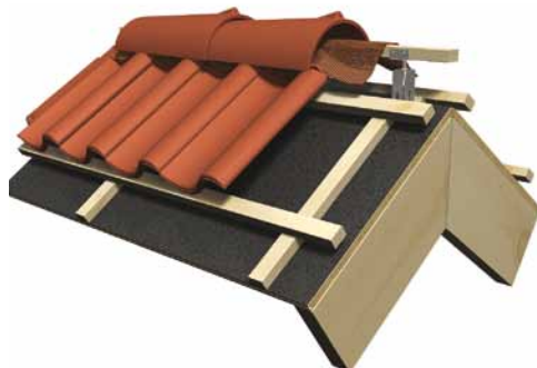
Bild 10. Det är viktigt att nock- och valmtätningssrullen inte ligger mot sidorna på nockplankan, utan endast i ovankant. Då luftas nockplankan ordentligt.
