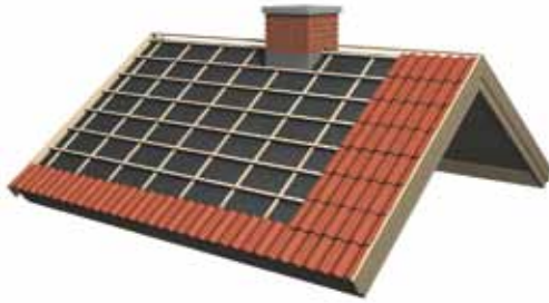
Bild 10. Läggs först en nedre rad från höger till vänster. Forsätt sedan med en rad ända upp tillnocken. Se till att den ligger i vinkel mot nedersta pannraden. Fortsätt med två - tre rader i taget ända upp. Kontrollera att raderna ligger rakt.
