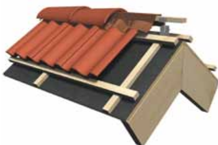
Bild 13. Benders nock och valmtätningrulle är lätt att montera. Rulla ut en längd på nockplankan, spika eller häfta fast den. Ta sedan bort skyddstejpen på undersidan av rullen och tryck fast och forma mot takpannorna.
