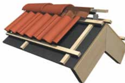
Bild 3. Avståndet från nockspetsen till övre bärläkten skall vara ca 25 mm, se bild 5. Prova att nockpannan täcker översta pannradens spikhål.
