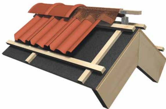
Bild 11. Det är viktigt att nock- och valmtätningssrullen inte ligger mot sidorna på nockplankan, utan endast i ovankant. Då luftas nockplankan ordentligt.
